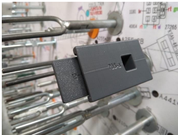
Рис. 1 – Деталь надрукована на 3д принтері із рухомою зачіскою і демонтажним отвором для неї
