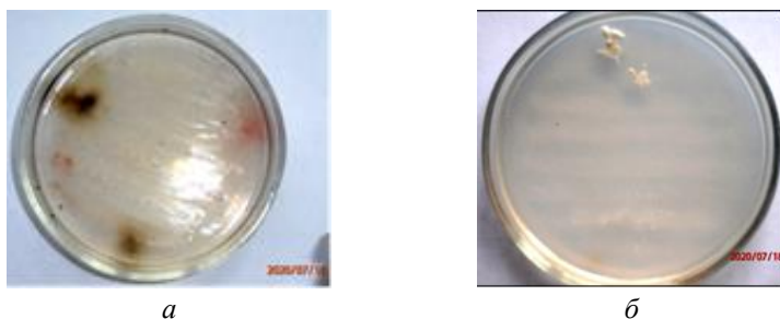
Рис. 3 – Фотографії росту колоній на контрольному зразку та після оброблення кавітацією 20 хвилин:
