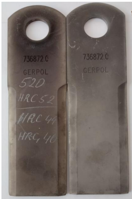
Рис. 1 – Зовнішній вигляд ножів подрібнювача соломи комбайна CLAAS Lexion після зміцнення БАТФ
