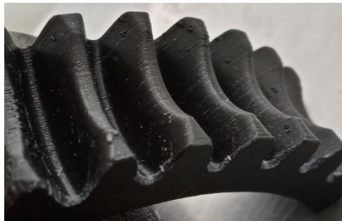
Рис. 4 – Фрагмент черв'ячного колеса отриманого 3D друком
